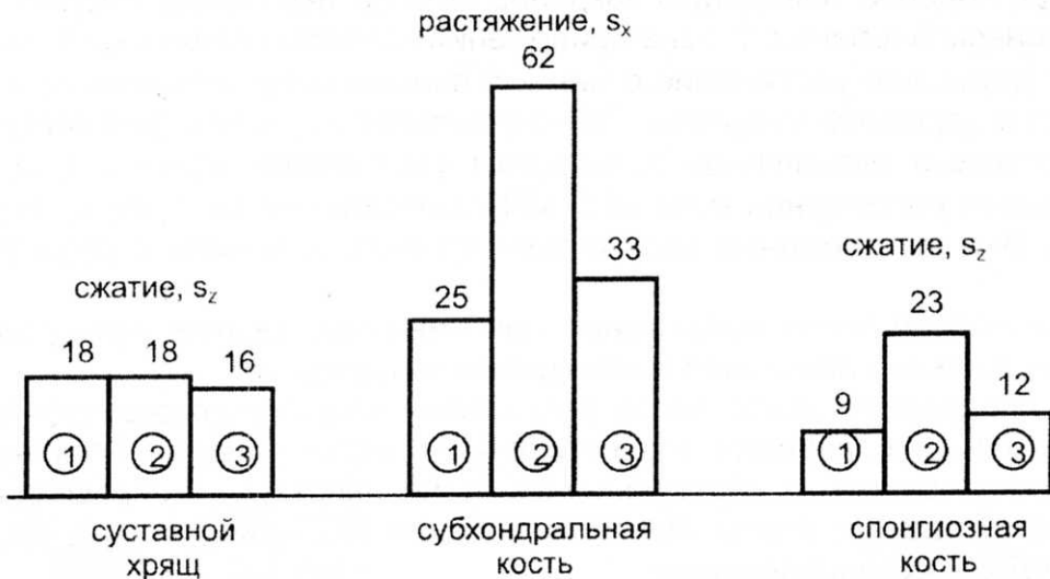
Рис. 3. Гистограмма максимальных расчетных напряжений (МПа) в структурах проксимального метаэпифиза большеберцовой кости:
