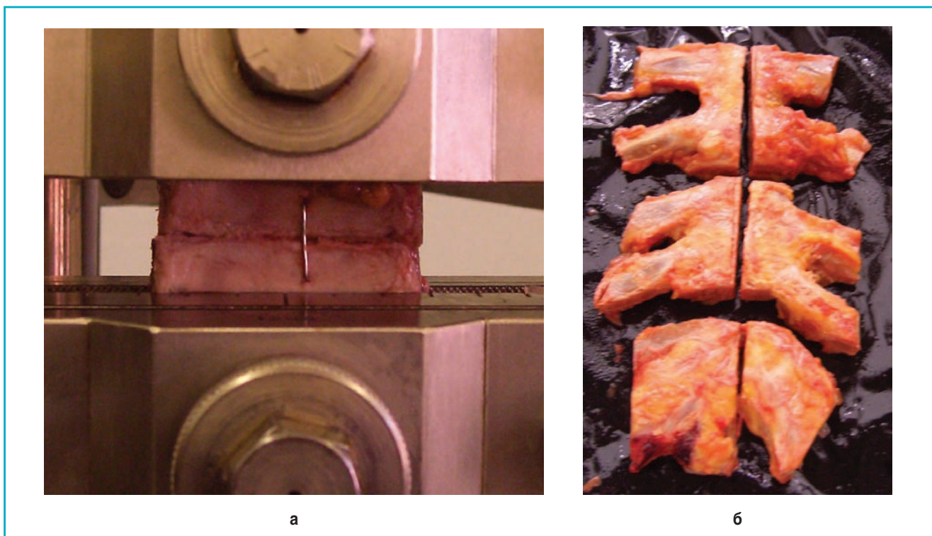
Рис. 3 Фрагменты костного материала грудины, предназначенные для испытаний на растяжение: а – грудина, разрезанная на фрагменты; б – образец для испытаний, сшитый стальной проволокой и установленный в захваты испытательной машины
