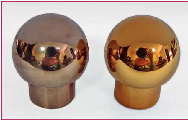
Рис. 2 Головки эндопротеза тазобедренного сустава из сплава ВТ6 после ВИПА (а) и дополнительного нанесения нанометрического слоя TiN конденсационным методом (б)
