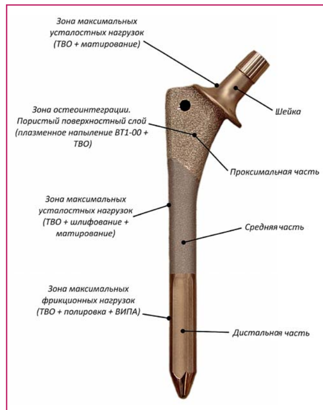
Рис. 1 Ножка бедренного компонента эндопротеза тазобедренного сустава и применяемые технологии обработки, обеспечивающие требуемый комплекс функциональных характеристик
