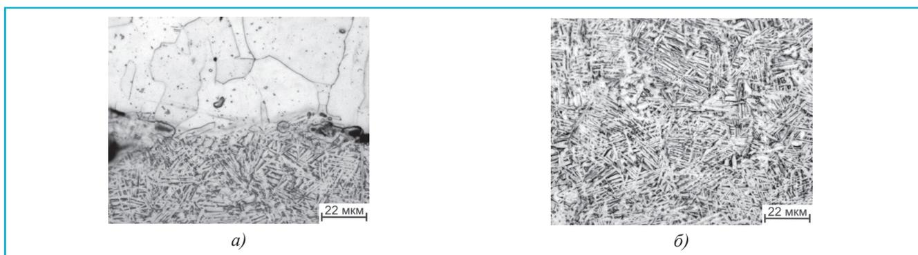
**Рис. 3** Граница раздела покрытия, полученного методом плазменного напыления, с основой (а) и структура основы из сплава ВТ6 (б)
