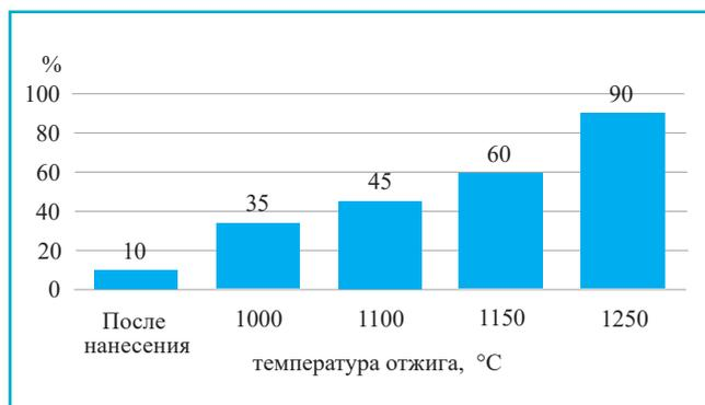
**Рис. 5** Влияние температуры вакуумного отжига на долю физико-химического контакта основа-покрытие образцов при плазменном напылении
