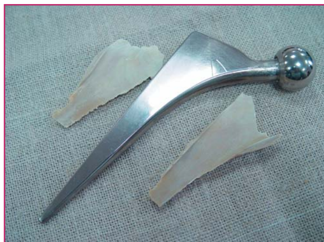
Рис. 3 Ножка и головка эндопротеза тазобедренного сустава из титанового сплава ВТ6 с наноструктурной коррозионно- и износостойкой поверхностью и с фрагментами цементной мантии после 6 лет эксплуатации в организме человека: износ всех компонентов отсутствует
