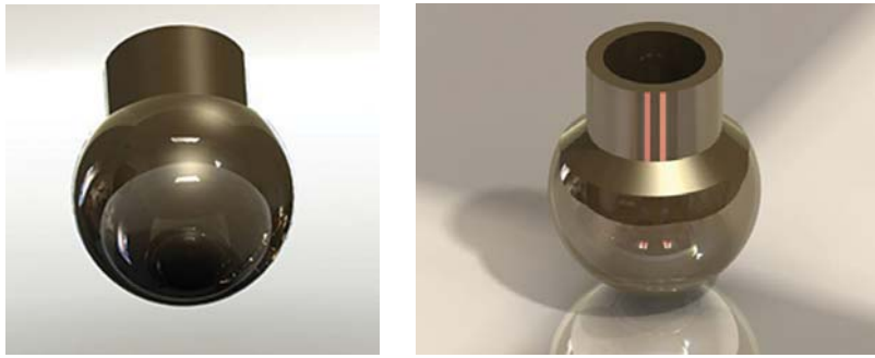
Рис. 1 Головка эндопротеза тазобедренного сустава с покрытием TiN. Выделена зона исследования структуры покрытия
