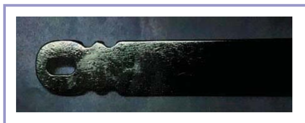
Рис. 7. Фотография растрова (пятнистой коррозии) поверхности имплантата. Fig. 7. Implant spotty corrosion.
